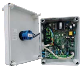
po demontáži víka je vidět digitální regulátor se sériovým rozhraním a konektor RJ 45 pro připojení programátoru
