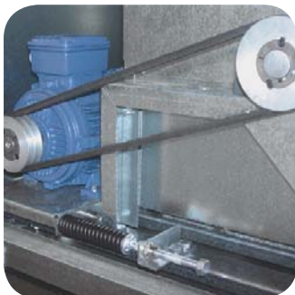
řemenový převod s automatickým napínáním řemenu pro bezúdržbový provoz
