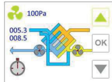
změna otáček ventilátorů pomocí nastavení tlaku
